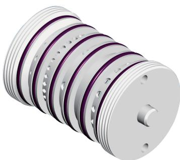
气动隔膜泵空气控制系统通过隔膜运动间接控制，确保自动操作。在冲程末端，自动反向运动，由一片隔膜吸入介质，另一片隔膜排出介质，以相反方向进行同样的操作。
