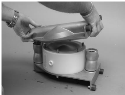
Gehäusewange (1) und Anschlussstutzen (2) abnehmen.
