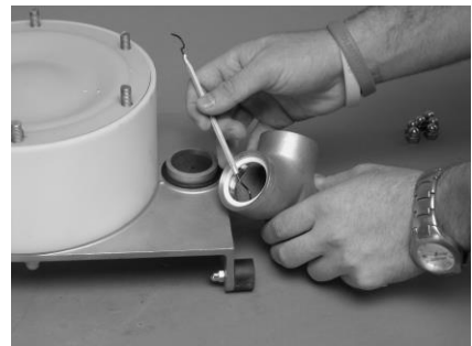
O-Ringe (7) von den Gehäusewangen abziehen; O-Ringe (6) für eventuellen Austausch den Anschlussstutzen (2) entnehmen.
