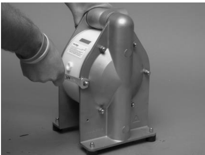
Zuganker (8) auf einer Seite der Pumpe lösen.
