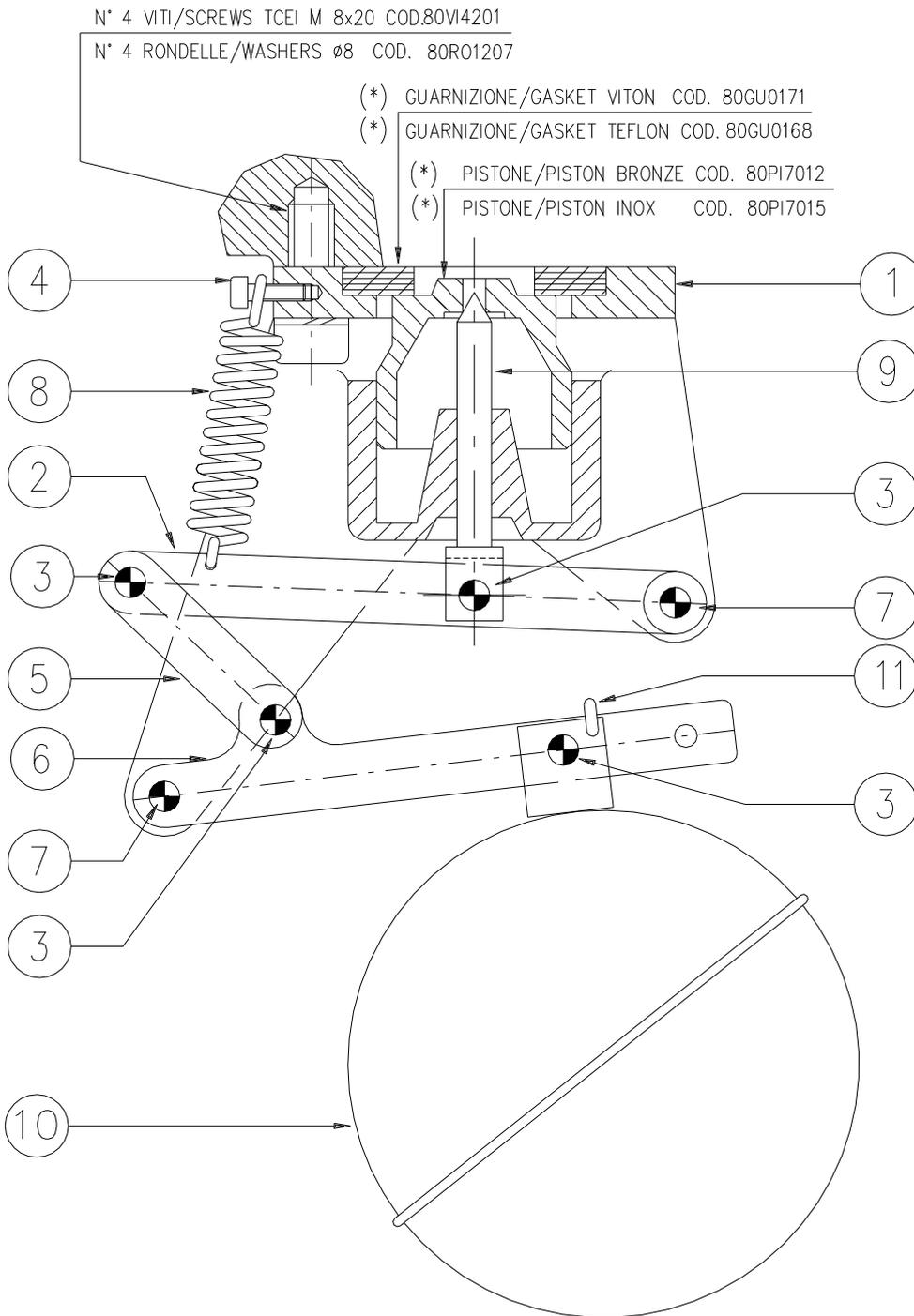
ASSIEME VALVOLA DEGASATRICE DIS. 565 GALLEGGIANTE Ø90 { COD. 80VA4021
