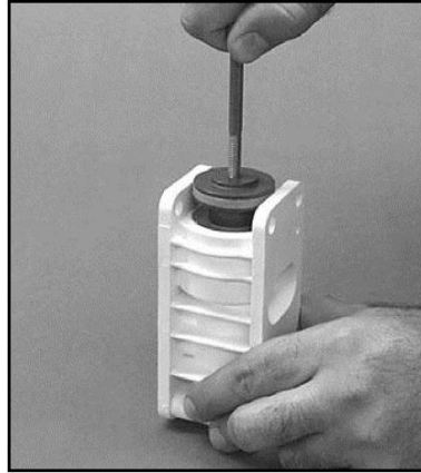
步骤 5 将气阀螺栓穿过阀芯的端头，轻轻将阀芯滑出气阀，拆除气阀阀芯。检查密封件是否由磨损，必要时替换整个组件。处理气阀阀芯，放置密封件损坏时，应谨慎操作。
